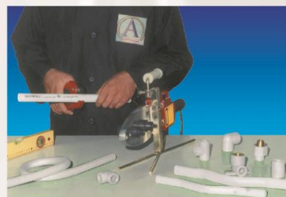
برش لوله و اتصال با قیچی مخصوص
