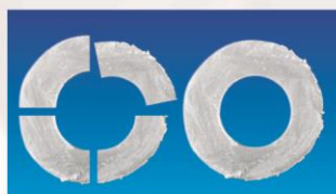
نمونه برش لایه نازک حلقه ای با جوش ایده آل
