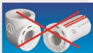
نمونه برش لوله و اتصال با جوش ناقص
