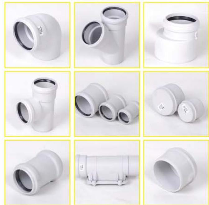
لوله و اتصالات KG کاربرد سیستم فاضلابی سوپردرین ۷ را به انتقال فاضلاب ساختمان به صورت دفعی در محوطه، پارکینگ‌ها و مانند آن گسترش می‌دهد. حلقه‌های آببندی به صورت انحصاری و خاص طراحی شده است تا آببندی کامل را در شرایط سخت تامین کرده و از آلودگی خاک جلوگیری کند. این حلقه‌ها از جنس SBR بوده و در مقابل مشتقات نفتی مقاوم است که KG را مثلاً برای محوطه‌ی پمپبنزین‌ها ایده‌آل می‌سازد.
